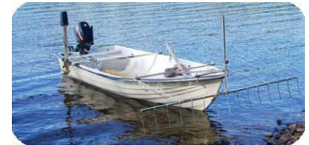
Der **Schilfrechen** erleichtert das Arbeiten mit den Dorocuttern. Störender Schilf wird durch den Rechen vom Propeller ferngehalten. Geeignet für die Verwendung mit Hymo, Klippo, Wasse und Elis.
