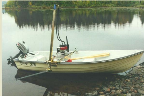
Der **Dorocutter Hymo** ist uns Mähwerk für größere Tiefen. Als Antrieb dient unser Hydraulikaggregat **Hyddo 200**, das einen zuverlässigen Betrieb garantiert. Das Hydraulikaggregat ist im Lieferumfang enthalten. Standardmäßige Steinsicherung.
