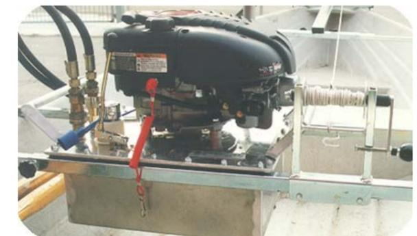
Der **Hyddo 200** kann als separates Bauteil einfach montiert und wieder abgenommen werden. Die Abgase werden über ein verlängertes Abgasrohr vom Fahrersitz weggeleitet. Da alle hydraulischen Komponenten im Hydrauliktank verbaut sind, kann kein Öl auslaufen. Der Motor kann vom Fahrersitz aus gestartet werden. Der **Hyddo 200** dient als Antrieb für die **Modelle 3070 und Hymo**, ist aber auch als Antrieb für anderer Hydraulikmaschinen geeignet.
