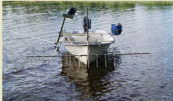
Der **Dorocutter Klippo** ist unser Mittelgewicht. Mähtiefe und Stellung der Messer werden vom Fahrersitz aus eingestellt. Für das Mähen in Ufernähe und bei dichtem Pflanzenwuchs kann das Messer auch gekippt werden. Der **Klippo** verfügt über eine Steinsicherung und einen verstellbaren Montagerahmen für verschiedene Bootsbreiten. Die Plastikeimer dienen als Gegengewichte (Ballast). Der Rahmen wird mit Verschlussbügeln an der Reling befestigt.
