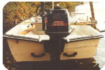
Ein seitlich montierter Schilfmäher zieht das Boot zu Seite. Ein zur selben Seite versetzter Motor kann dies ausgleichen.
