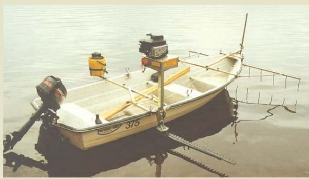
Der **Dorocutter Wasse** ist unser kleinster motorbetriebener Schilfmäher. **Wasse** ist besonders für die Pflege kleinerer Gewässer und für den Wechsel zwischen verschiedenen Gewässern zu empfehlen. Mähtiefe, Stellung der Messer und Antrieb werden vom Fahrerplatz aus gesteuert. Seine leichte Bauweise gewährleistet einfachen Transport und Montage. Standardmäßige Steinsicherung. Ein Schilfrechen ist als Zubehör erhältlich.
