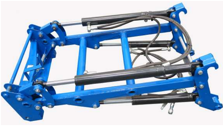
Parallel arbeitender Hubarm. Einfacher Werkzeugwechsel durch die halbautomatischen Schnellwechsler X4.
