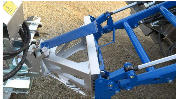
Parallel arbeitender Hubarm. Einfacher Werkzeugwechsel durch die halbautomatischen Schnellwechsler X4.
