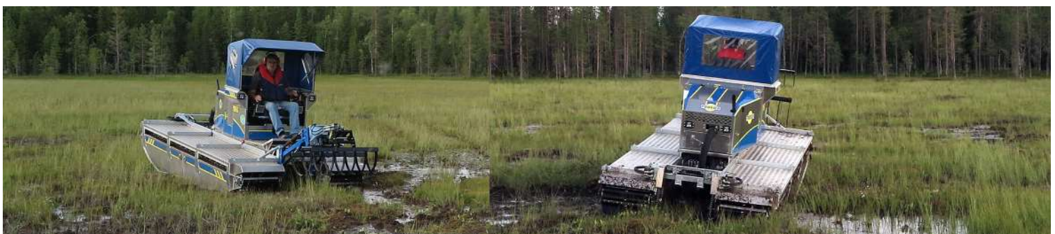
Auch auf schwierigem Untergrund sorgt das System der Gewichtsverteilung für einen niedrigen Bodendruck und gute Watfähigkeit der Maschine.
