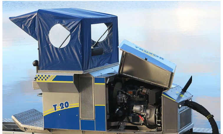
Lättåtkomligt motorrum underlättar service.
