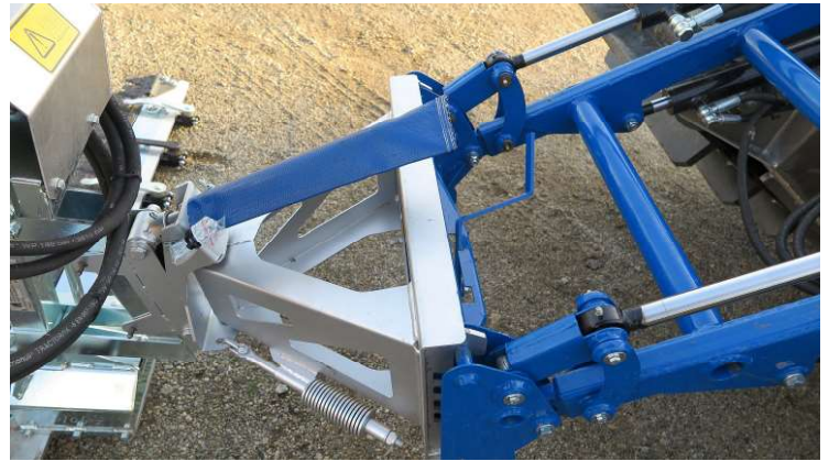
Lyftarm med parallellföring. Verktygsfäste utrustat med halvautomatiskt snabbfäste X4 för snabbt byte av verktyg.
